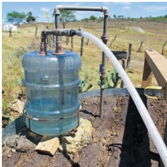
Galão de água utilizado no sistema biodigestor para a produção de gás natural.
